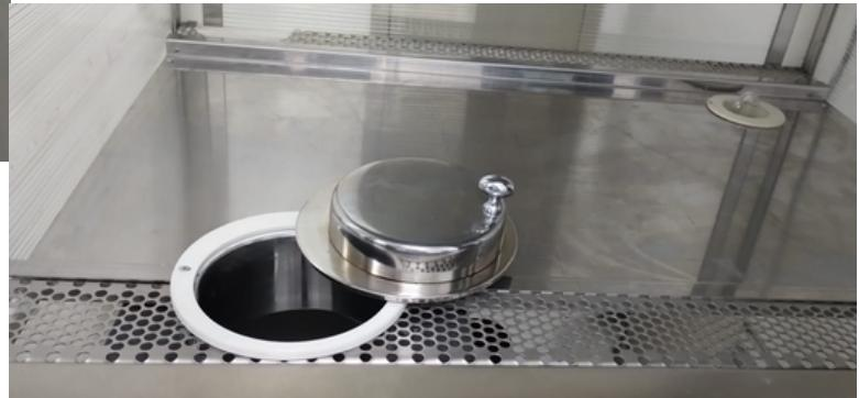
*Dentro de la cabina de flujo laminar se instalaron el contenedor de generador de tc99 y el activímetro*
